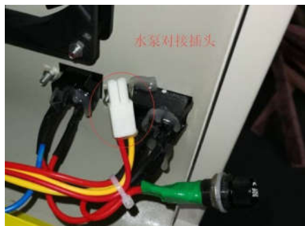
图 2-4：右侧机壳内的“水泵插口”示意图
